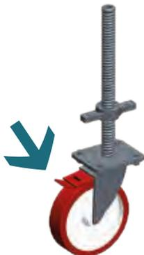
Le réglage des pieds à roues se fait grâce à la tige filetée et son écrou à manette avec une course maximale de 200 mm. Il doit seulement être utilisé pour régler les défauts de géométrie du sol. Sur des sols plats, il est recommandé de maintenir l'écrou au plus bas.
