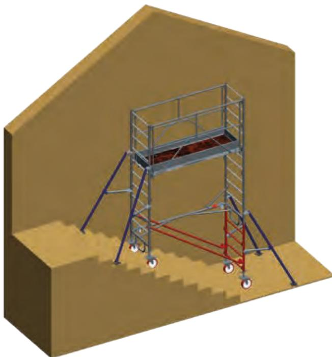
A la différence d'un montage standard, glisser l'échelle (manchons vers le haut) du kit escalier entre la base et les vérins coté bas de l'escalier. Ajouter obligatoirement les diagonales du kit sur chaque montant de l'échelle. Ces diagonales seront fixées sur le béton à balourd de la base pour la partie supérieure de l'escalier et via une pince sur la partie inférieure. Le positionnement des stabilisateurs doit respecter les préconisations énoncées au chapitre « montage des stabilisateurs ».
